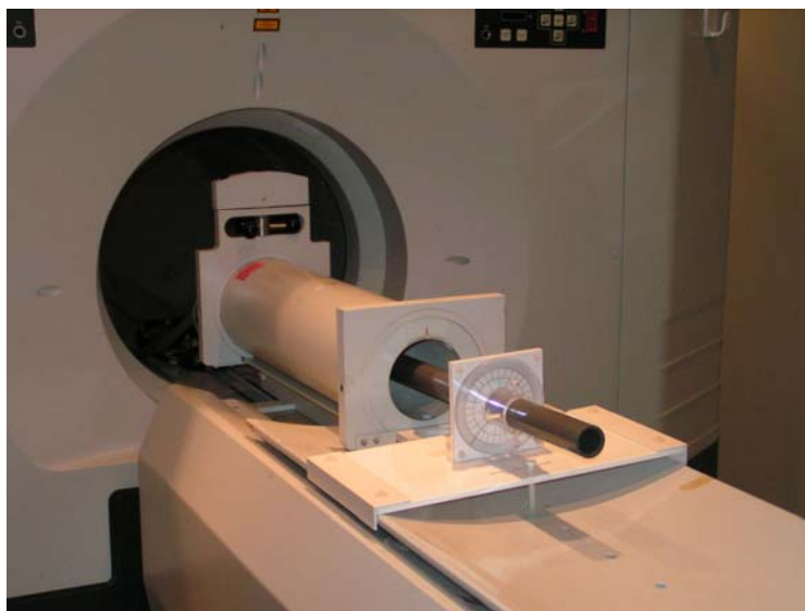
Obr. 4.1 MR kompatibilné kompresné zariadenie umiestnené v mikrogradientovom systéme BGA 12. Pomocou otočnej tyče a mierky je možné dosiahnuť posunutie piestu s presnosťou 1/100 mm v pozdĺžnom smere a kontrolovať tak tlak pôsobiaci na vzorku chrupavky.
